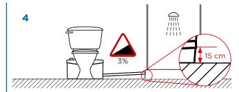
Sorgen Sie für ein Gefälle zwischen den Sanitäranlagen und der Hebeanlage (optimal sind 3 %). Von Unterkante Gerät bis Unterkante Duschwanne mind. 15 cm Höhendifferenz (bei max. 1 m Abstand) einhalten. Je Zusatzmeter 1 cm Höhendifferenz zugeben.
